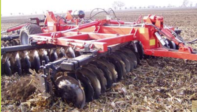
Naprzemienne rozmieszczenie talerzy gładkich i zębatach w bronach talerzowych zapewnia dobre zagłębienie się narzędzia na polach z dużą ilością resztek poźniwnych.
