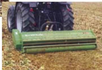
Rozdrabniacz uniwersalny Kornik XL z powodzeniem może być wykorzystywany do rozdrabniania ścierniska i łodyg po zbiorze kukurydzy.
