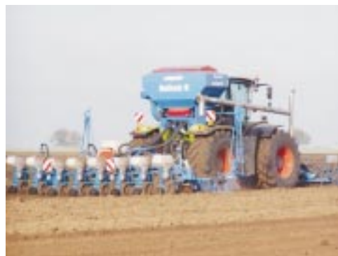
Fot. 1. Siewnik punktowy do kukurydzy Monosem firmy Compagnie Ribouleau; brona wirnikowa Zirkon 9, siewnik pneumatyczny Solitair 9 oraz czołowy wał Campbella firmy Lemken współpracujące z ciągnikiem Xerion firmy Claas.
